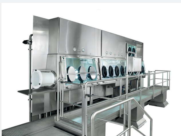
Ejemplo: Aislador para mezclar productos activos HAPI con excipientes y dispensarlos.
